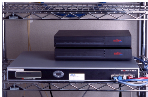
センター側で稼働するVPNスループット80Mbpsの「FortiGate-400」。光回線を2系統引き込み、耐障害性を向上させている
