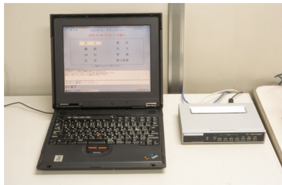
125拠点の各店舗にはVPNスループット20Mbpsの「FortiGate-60」を導入している
